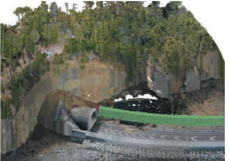
土砂崩落が発生した場合でも、三次元点群データを取得することで安全に被災直後の状況を確認し、早急な土砂撤去に移行可能です。点群データから図面を作成し、適確な復旧計画を行います。
