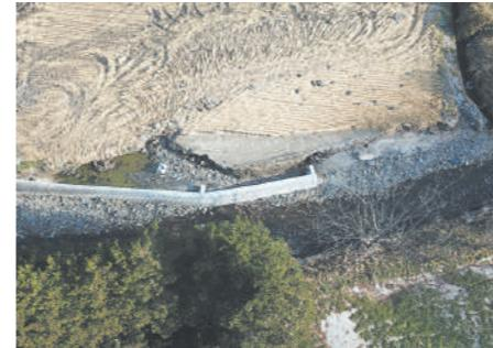
上空が開けている河川や農地などに対してUAVにより空撮することで、広範囲の被災現場や接近が危険な現場の災害箇所の特定その規模などを把握することができます。
