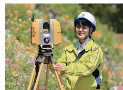
据置型3Dレーザスキャナ
