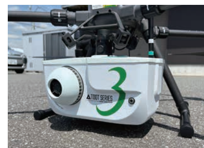
UAV搭載型グリーンレーザスキャナ
