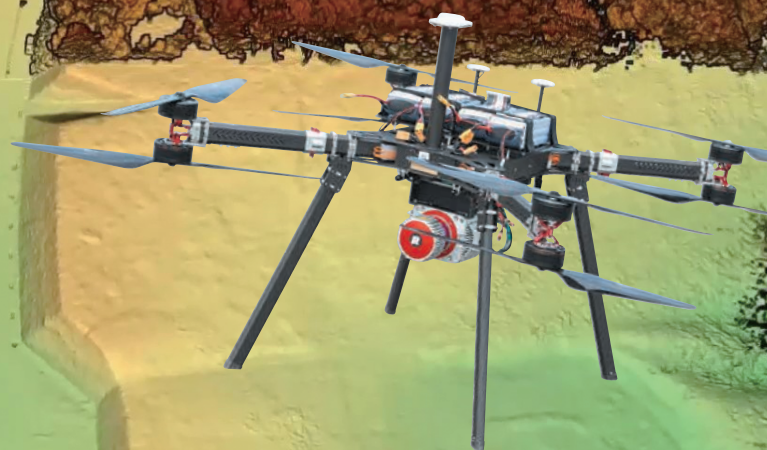
図：UAV レーザ測量による地形測量（地面フィルタリング）
