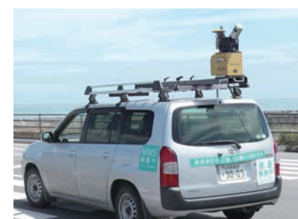
車載型3Dレーザスキャナ
