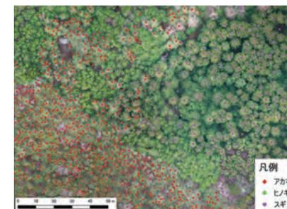
UAVレーザ測量による三次元点群データから得られる森林の表層、地盤高および樹冠形状等のデータにより、毎木位置および樹高を解析し、樹冠形状から材積量の推定まで行います。
