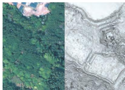
UAVを用いた写真撮影やレーザスキャンニングを行います。レーザスキャンニングでは森林内の地形測量が可能で、UAV写真や点群を用いて図面の作成を行います。点群データから動画の作成も行います。
