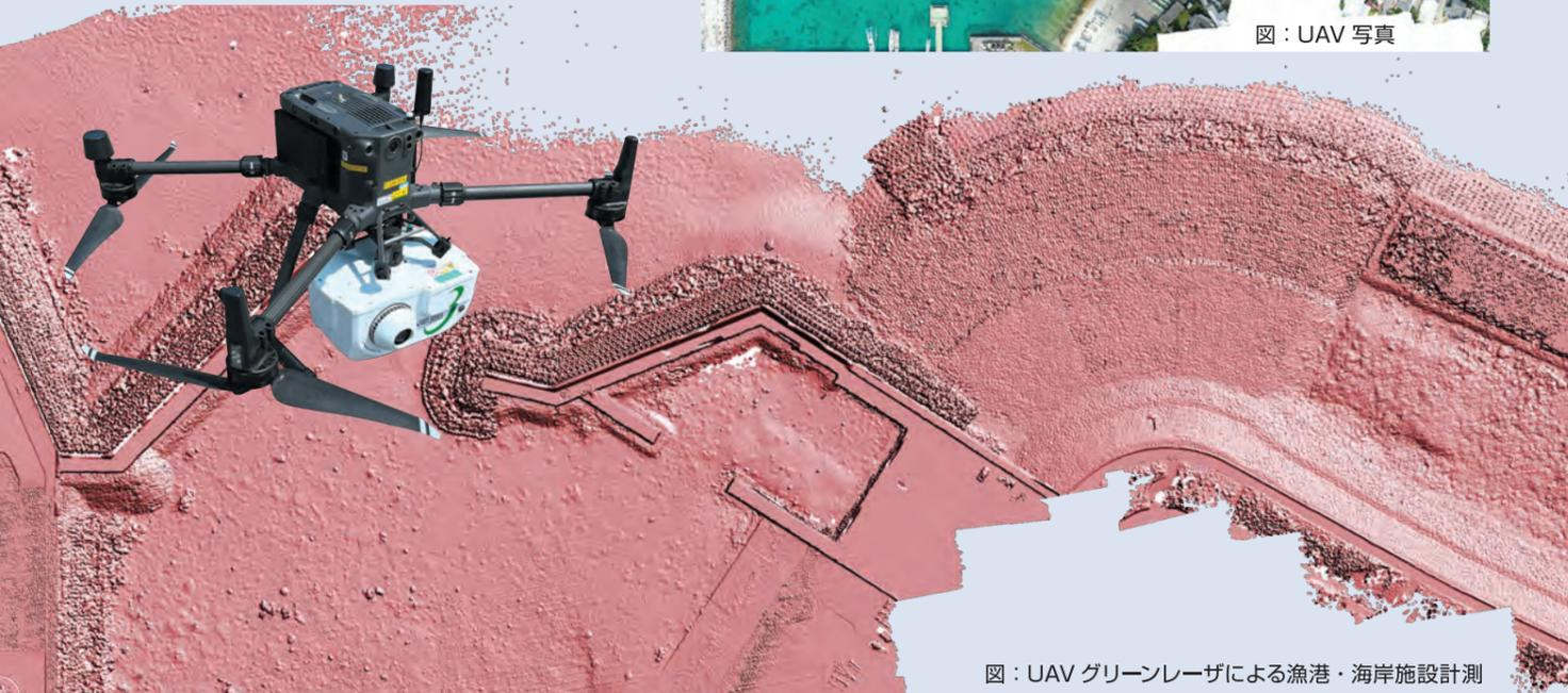
図：UAV グリーンレーザによる漁港・海岸施設計測
