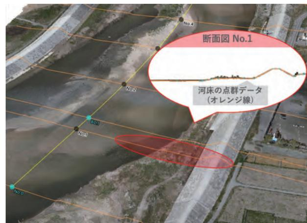
UAVグリーンレーザ測量は、河川の整備計画・河道掘削に伴う測量及び不等流計算等に活用できます。より詳細な調査が可能になるとともに、計画断面に対する堆砂及び洗堀量の算出や災害発生時の現況把握及び復旧工法の検討などにも活用できます。
